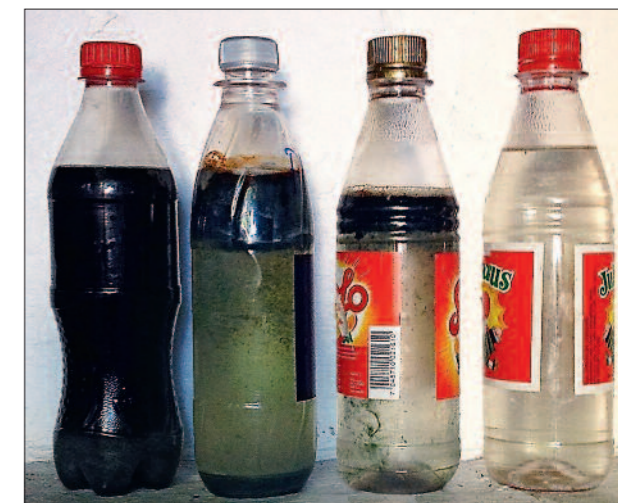
Gamle radiatorer inneholder mye partikler. Oland bestilte full radiatorrens. I tillegg er det nå montert på vannfilter med magnet.
